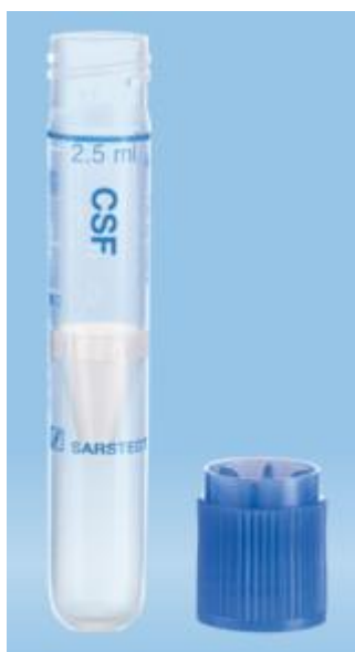
Ryc. 33. Probówka do badania płynu mózgowo-rdzeniowego z fałszywym dnem o pojemności 2,5 ml Źródło: katalog produktowy, materiały firmowe SARSTEDT Sp. z o.o., www.sarstedt.com
